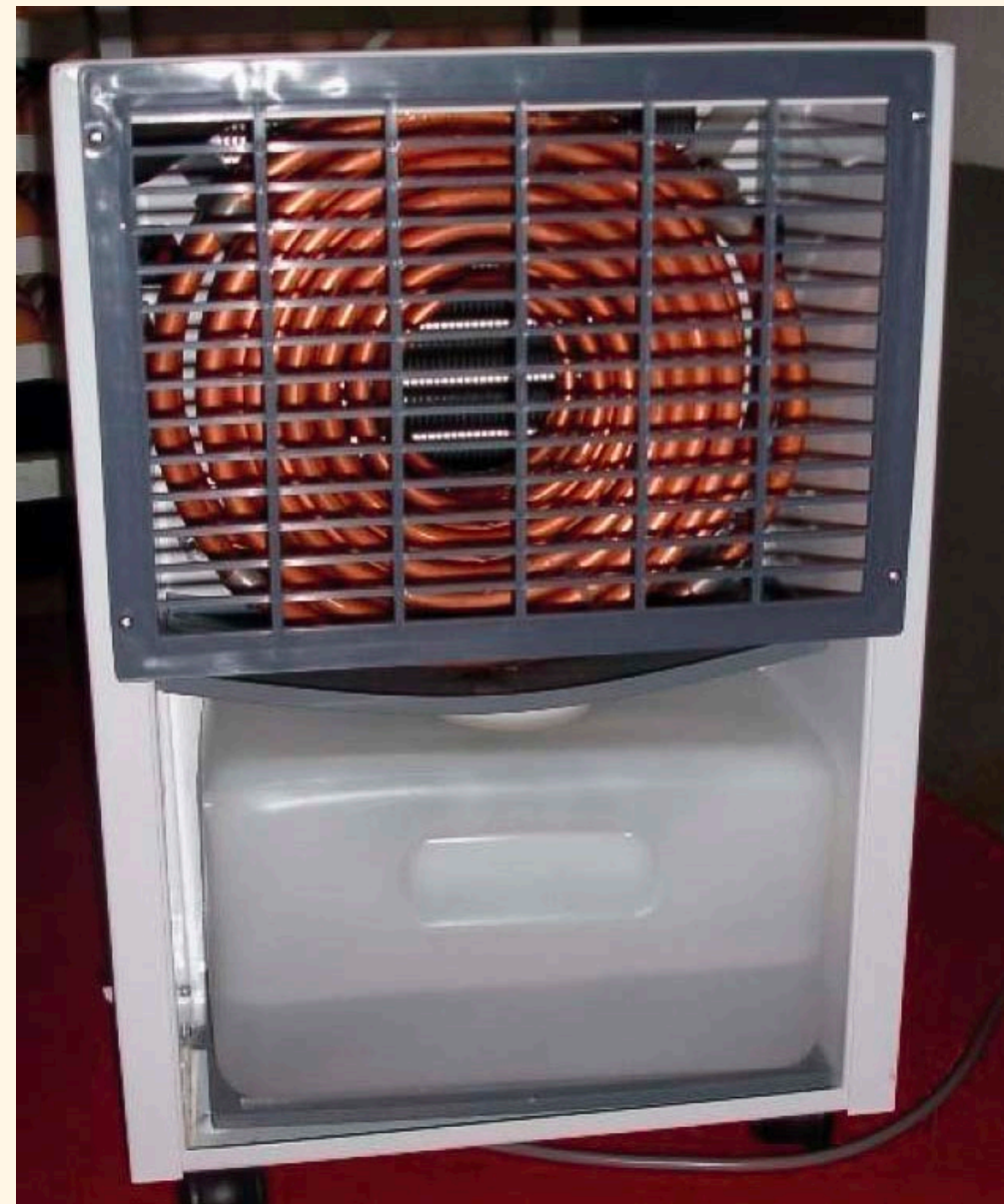
▼ Image 1. Un déshumidificateur installé dans une pièce préchauffée, dont le réservoir est rempli d'eau préalablement présente dans l'air sous forme de vapeur. En recueillant cette eau, l'humidité relative de l'environnement chute à un niveau tel que le point de rosée ne sera jamais atteint lors de l'introduction des œufs.
