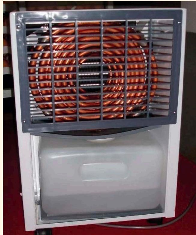
▼ **Bild.** Ein in einem Vorwärmraum installierter Luftentfeuchter, dessen Behälter mit dem Wasser gefüllt ist, das zuvor als Dampf in der Luft vorhanden war. Durch das Auffangen dieses Wassers sinkt die relative Luftfeuchtigkeit in der Umgebung auf ein Niveau, bei dem der Taupunkt beim Einlegen der Eier nicht erreicht wird.
