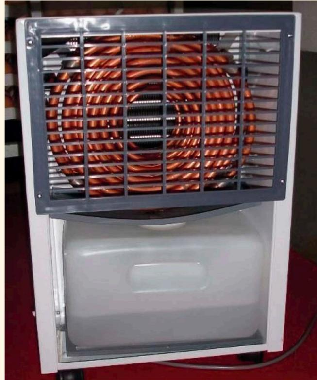
▼ **Imagen 1.** Deshumificador instalado en una sala de precalentado, el depósito se llena de agua que antes estaba en el aire como vapor. Al recoger esta agua, la humedad relativa del entorno disminuye hasta un nivel en el que no se alcanzará el punto de rocío al cargar los huevos.
