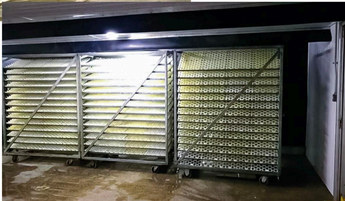
**Imagen 2.** Sala de precalentamiento actualmente con 300,000 huevos a la vez, donde se muestra la disposición de los deflectores y del carrito.
