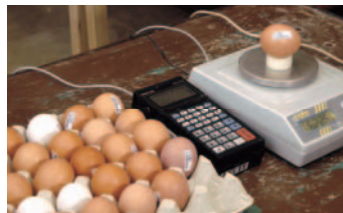
Pesaje del huevo correspondiente a cada gallina (izquierda) y medición de la resistencia al quiebre (derecha).
