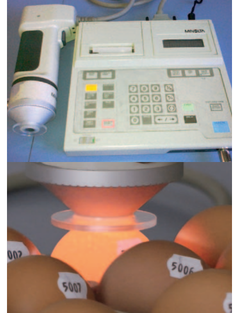
Ilustración 2: reflectómetro para la medición del color de cáscara
