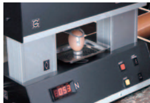
Pesaje del huevo correspondiente a cada gallina (izquierda) y medición de la resistencia al quiebre (derecha).
